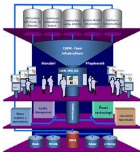
Obr. 11.1. Postavení CAFM v IT prostředí (EDMS znamená electronic data management system, pod pojmem e-výkresy se skrývají data poskytovaná CAD a GIS systémy)
