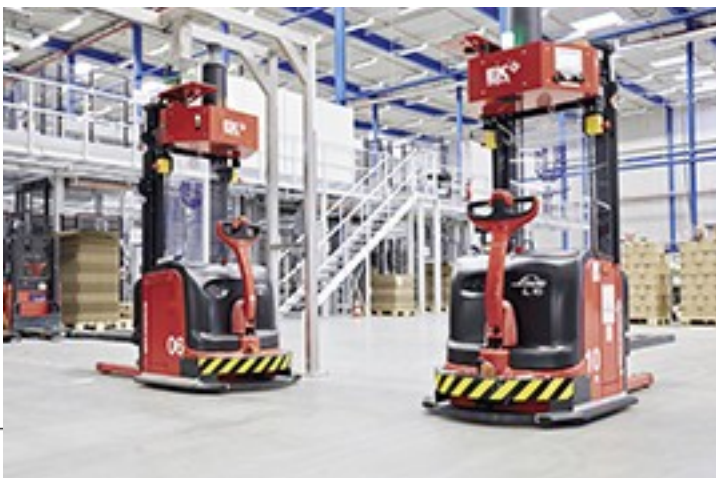
Plně automatický vidlicový zdvižný vozík bez řidiče - série LINDE L16
