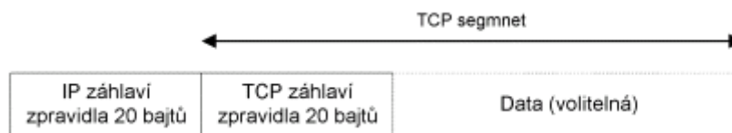
Obr. 21 TCP segment; zdroj: (4)
